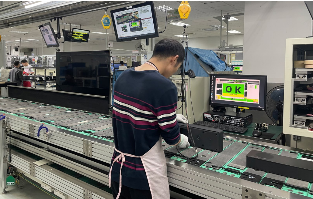
LGEHZ (惠州) 进行 DFT（驱动器健康检测技术）全检
