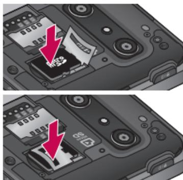
**警告：**请勿在手机开机时插入或取出存储卡。否则，可能损坏存储卡以及手机，并且存储卡上存储的数据也可能会损坏。
