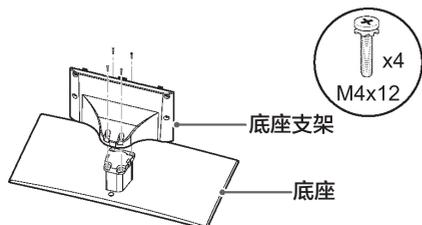
3. 将四个螺钉安装到电视机后盖上的孔中。
