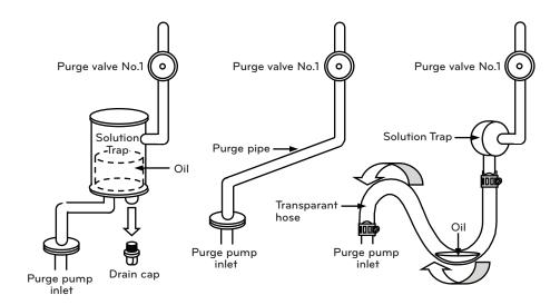
Figure 3-8. Solution trap
