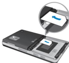
4. Para introducir la batería, alinee los contactos dorados de ésta con los conectores correspondientes del compartimento de la batería. Haga presión en el otro extremo de la batería hasta que entre en su sitio con un clic.
