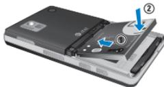
5. Vuelva a colocar la tapa deslizándola hacia arriba a su posición hasta que escuche un clic.
