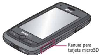
2. Inserte la tarjeta microSD con la etiqueta orientada hacia arriba y empújela suavemente hacia adentro hasta que encaje en la ranura. Si inserta la tarjeta en la dirección equivocada, podría dañar su teléfono o su tarjeta.
