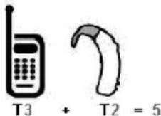
En el ejemplo antes señalado, si un aparato para sordera cumple con la clasificación de nivel M2 y el teléfono inalámbrico cumple la clasificación de nivel M3, la suma de los dos valores es igual a M5. Esto debería proporcionar al usuario del aparato para sordera un "uno normal" al usar su dispositivo auditivo con ese teléfono inalámbrico en particular. "Uso normal" en este contexto se define como una calidad de señal que es aceptable para el funcionamiento normal.
