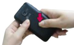
**3** Coloque la tapa de la batería sobre el compartimiento de la batería y luego presione la tapa hacia abajo hasta que encaje en su lugar.
