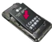
**2** Alinee los contactos de la batería con los terminales en el compartimiento de la batería y empuje la batería hacia abajo hasta que encaje en su lugar.
