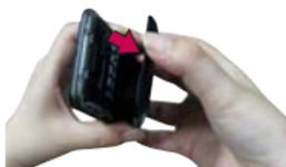
**1** Use la abertura de dedos en la parte inferior del teléfono para extraer la tapa posterior.
