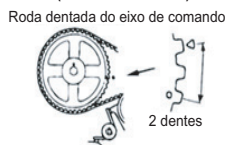
Figura 8. Ajustando a tensão (roda dentada do eixo de comando)
