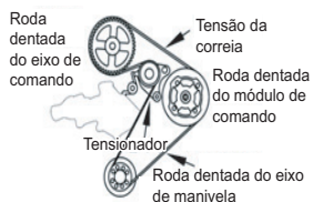
Figura 6. Montagem da correia
