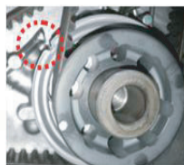
Figura 4. Posição da roda dentada do eixo de manivela
