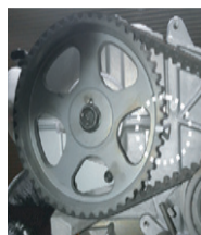
Figura 2. Posição do eixo de comando (posição do ponto morto superior de compressão do cilindro nº 1)
