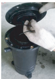
Figura 5. Verificação do anel O-ring
