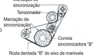
Figura 11. Marca sincronizadora (correia sincronizadora B)
