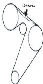
Figura 9. Verificando a tensão
