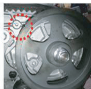
Figura 3. Posição da roda dentada do módulo de comando
