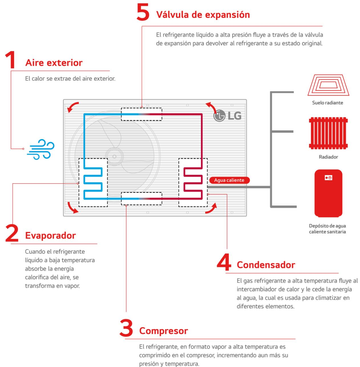
La aeroterminia híbrida utiliza la tecnología VRF y presenta grandes ventajas frente a otros sistemas de climatización. Combinando una unidad exterior Multi V S R32, un Hidrokit, un depósito de ACS y una o varias unidades interiores, disponemos de producción de agua caliente sanitaria, calefacción y refrigeración en un mismo sistema con la particularidad de que la refrigeración se produce por expansión directa, siendo más adecuada para zonas de costa.
