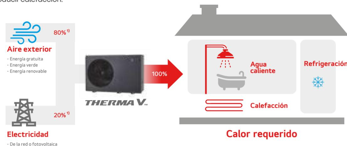
1) El coeficiente de rendimiento es para ayudar a la comprensión general y se basa en el coeficiente estacional de rendimiento (SCOP) de THERMA V R290 Monobloc en condiciones de baja temperatura y clima medio, que es superior a 5. El rendimiento real puede variar en función de la temperatura del agua y del exterior.
