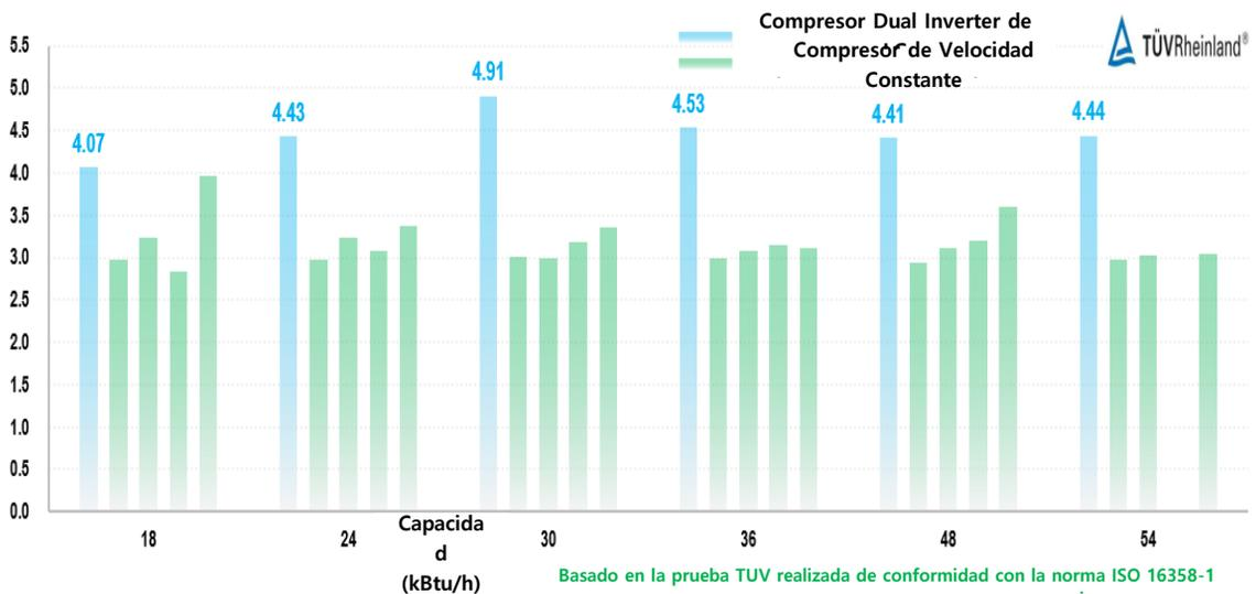
**El CSPF (Factor de Rendimiento Estacional de Enfriamiento) de los compresores Dual Inverter de LG es más alto que el de los compresores de velocidad constante.**
