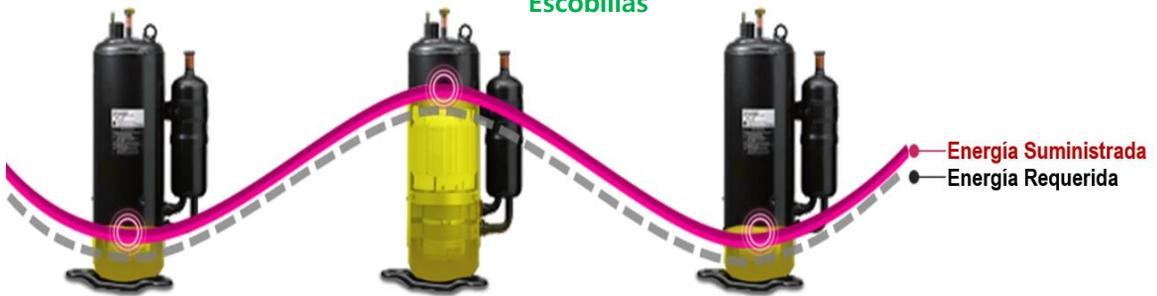
Como la energía se suministra de acuerdo con la carga requerida, se reduce la energía desperdiciada.
