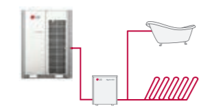
Ciepła woda + Ogrzewanie podłogowe
