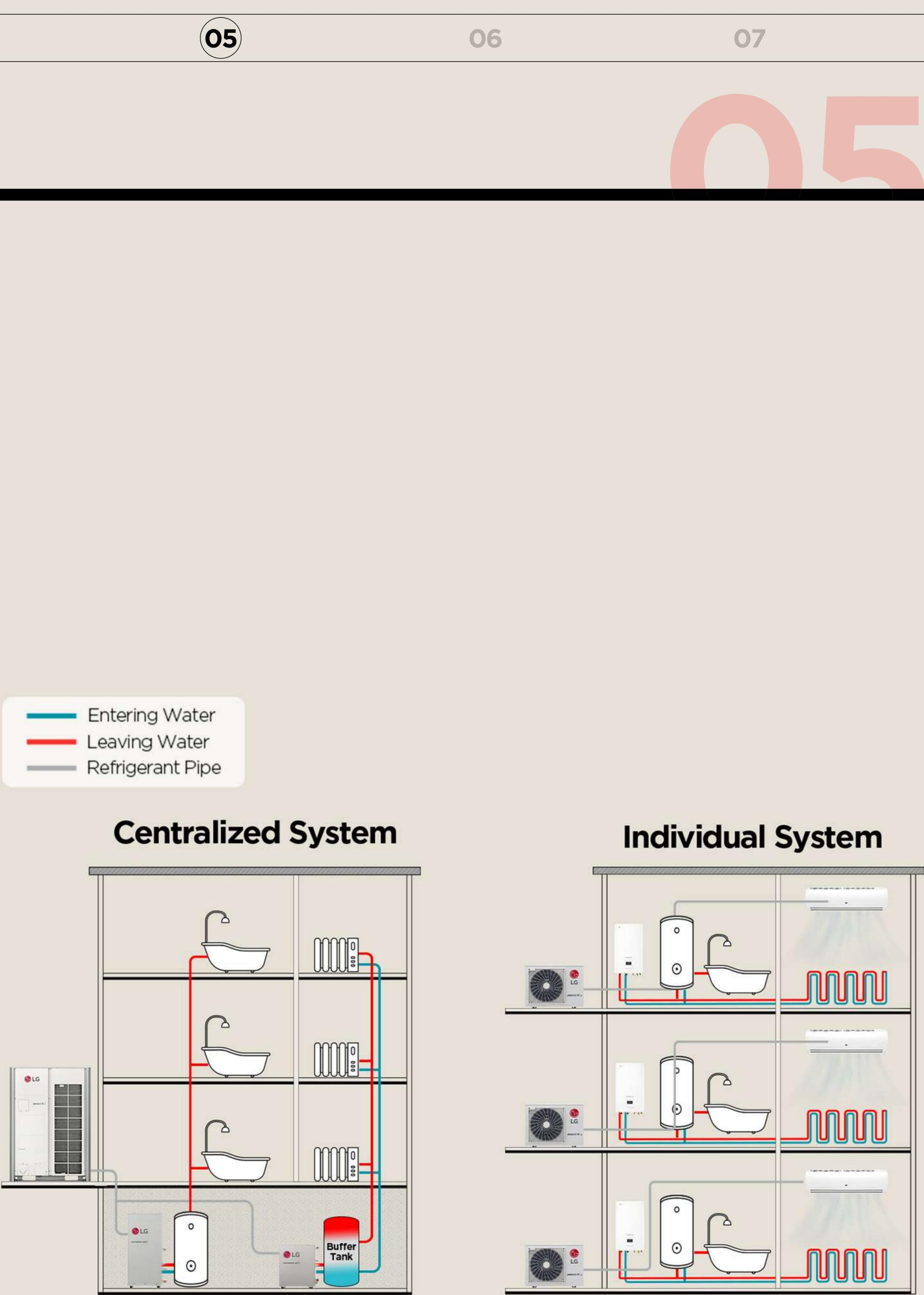
VRF + Floor Standing Hydro Kit(MT/HT) + Buffer Tank + DHW Tank
