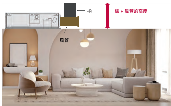
吊隱式風管安裝示意
