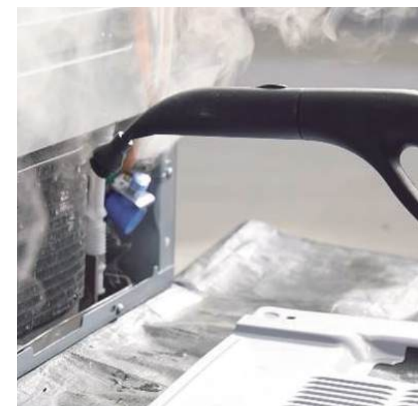
蒸氣清潔冷凝器
