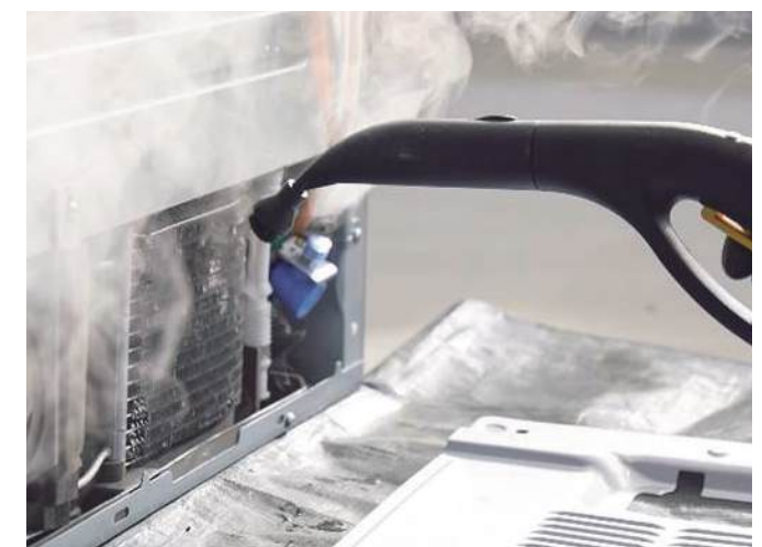
蒸氣清潔冷凝器
