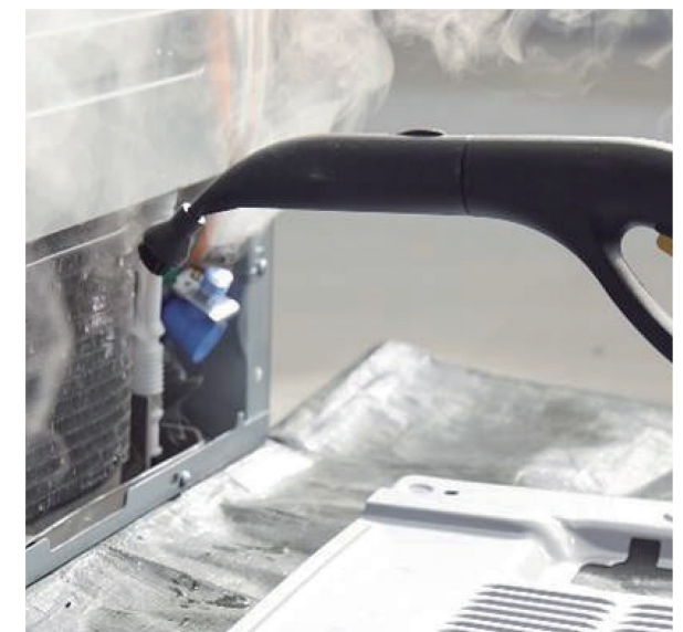
蒸氣清潔冷凝器
