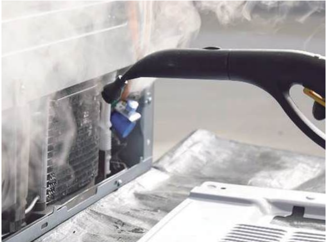
蒸氣清潔冷凝器
