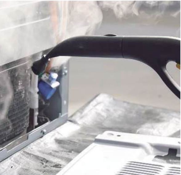
蒸氣清潔冷凝器
