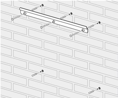
Fixe o suporte de instalação com parafusos e buchas de fixação.
