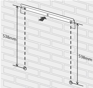
Coloque o suporte de instalação numa parede que cumpra todas as condições de instalação e folga.
