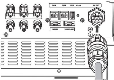
Conecte a ficha do cabo CA ao conector do cabo CA da rede bateria na parte inferior do produto.
