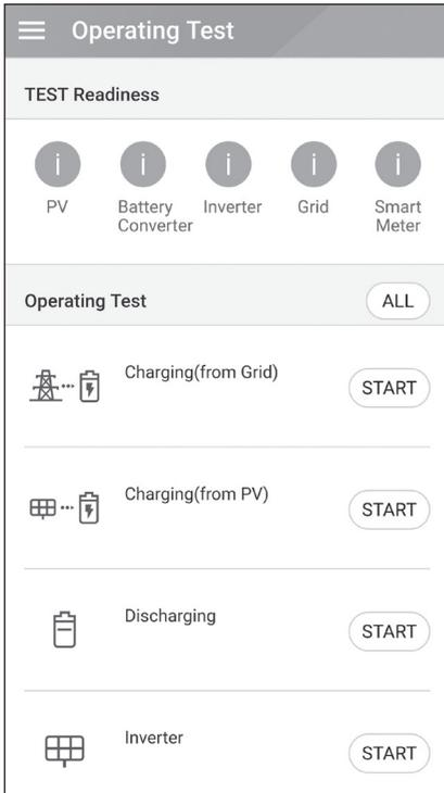
Selecione [Operating Test] em [Installer Settings]. O menu de teste de funcionamento é exibido.
