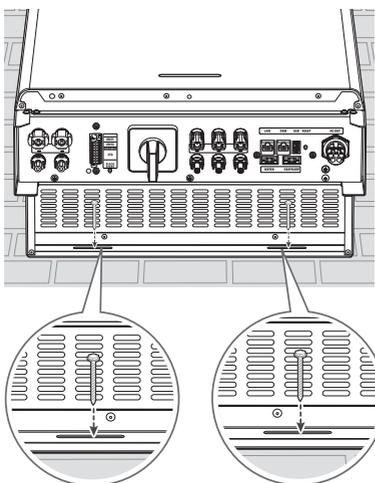
Faça furos nas posições marcadas e fixe o produto à parede com os parafusos e as buchas de fixação.
