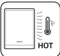
O lado direito do PCS instalado pode ficar quente devido ao calor da saída de ar. Não coloque quaisquer objetos perto da saída de ar.
