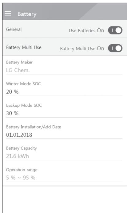
As opções [Battery maker], [Operating range], [Winter Mode SOC] [Battery Installation Date] e [Battery Capacity] podem ser definidas manualmente.
