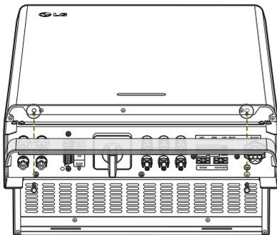
Após terminar todas as conexões elétricas, monte a cobertura inferior fornecida e aperte os parafusos como ilustrado na figura.
