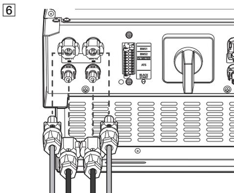
Conecte as fichas de ambos os cabos da bateria aos conectores do cabo CC da bateria na parte inferior do produto.
