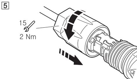
Pressione o inserto dentro da manga e fixe o prensa-cabos à caixa com uma chave de 15 mm. (2 N.m)
