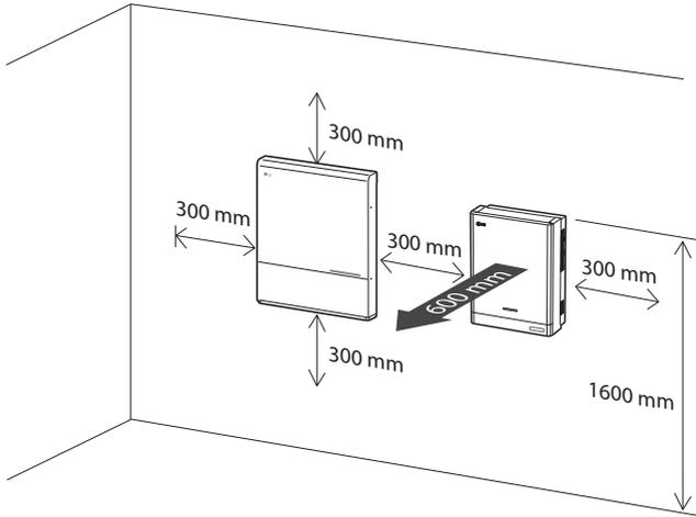
Este produto deve ser instalado deixando uma folga do lado esquerdo, direito, superior, inferior e à frente do produto, conforme ilustrado na figura.
