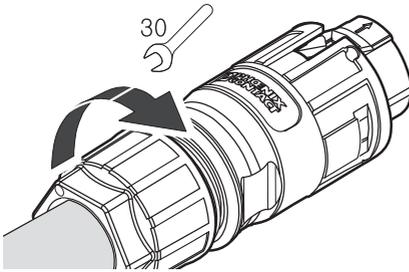
Monte o selo de borracha na caixa e fixe o prensa-cabos usando uma chave inglesa de 30 mm. (4,5 N.m)
