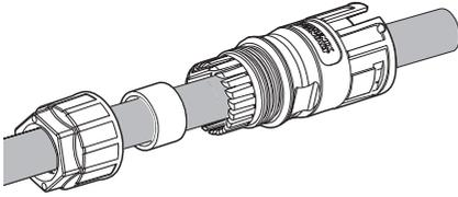
Passo o cabo CA através do prensa-cabos, do selo de borracha e da manga, como mostra a figura.
