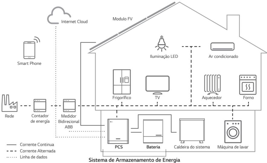
A eletricidade gerada a partir de um PV pode ser armazenada na bateria conectada ou vendida a empresas de fornecimento de energia.
