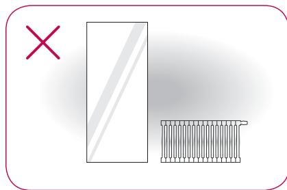
Verificați zona de instalare și reinstalați-l departe de obiecte generatoare de căldură.
