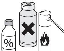
Neizsmidzniet ūdeni vai uzliesmojošas vielas (zobu pasta, alkohols, šķīdinātājs, benzols, uzliesmojošs šķidrums, abrazīvs materiāls u.c.) iekārtas tuvumā tās tīrišanas laikā. Iekārtas iekšpusē lietojiet tīru vai mīkstu drānu un siltā ūdeni izšķīdinātu vieglu mazgāšanas līdzekli. Nelietojet abrazīvus vaiasus tīrišanas līdzekļus. Rūpīgi nosusiniet ar mīkstu drānu.
