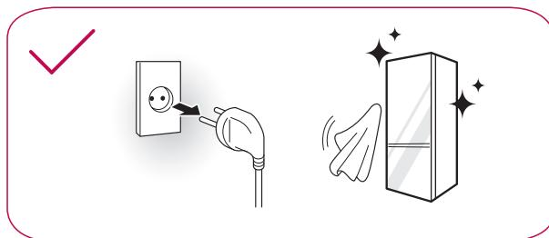
Bij het schoonmaken van de buitenkant van de ventilatieopeningen in het apparaat door middel van stofzuigen, moet het netsnoer worden losgekoppeld van het stopcontact om eventuele statische ontlading te voorkomen die de elektronica kan beschadigen of een elektrische schok kan veroorzaken.
