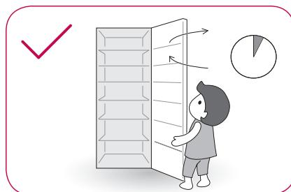
Als de deur langdurig wordt geopend, kan dit een aanzienlijke temperatuurstijging veroorzaken in de compartimenten van het apparaat.
