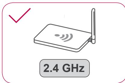
Če je razdalja med napravo in brezžičnim rutarjem predolga, postane moč signala šibka in povezava morda ni konfigurirana pravilno. Premaknite lokacijo rutarja, da je bližje napravi. Samo frekvanca rutarja 2,4 GHz je podprta. Nastavite rutar na 2,4 GHz in povežite napravo z brezžičnim rutarjem. Da preverite frekvenco rutarja, preverite pri dobavitelju vašega interneta ali izdelevalcu rutarja.
