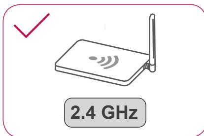
Se la distanza tra il dispositivo e il router fosse eccessiva, la potenza del segnale si indebolirebbe e la connessione potrebbe non configurarsi correttamente. Spostare il router perché sia più vicino al dispositivo.
