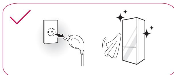
W przypadku czyszczenia zewnętrznych otworów wentylacyjnych za pomocą odkurzacza, wtyczka urządzenia powinna być odłączona od gniazda w celu uniknięcia wyładowań statycznych, które mogą uszkodzić elektronikę lub spowodować porażenie prądem.
