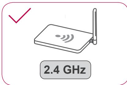
Ako je udaljenost između uređaja i bežičnog ruteru suviše velika, signal može da bude suviše slab i veza možda neće biti ispravno konfigurisana. Stavite ruter bliže uređaju. Podržani su samo ruteri čija je frekvencija 2,4 GHz. Podesite bežični ruter na 2,4 GHz i priključite uređaj na bežični ruter. Da biste proverili frekvenciju ruteru, обратите se провайдеру интернет услуга или производчу ruteru.
