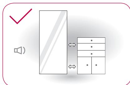
Ajuste a posição de instalação para existir folga suficiente à volta do equipamento.
