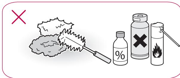
Spuit geen water of brandbare stoffen (tandpasta, alcohol, thinner, benzeen, brandbare vloeistof, schurende vloeistoffen, enz.) op de binnenkant of buitenkant van het apparaat om het te reinigen.
