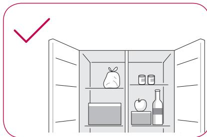
Stop niet teveel in het apparaat. Als het apparaat te vol zit kan de koude lucht niet goed circuleren.
