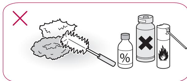
Czyszcząc wnętrze i powierzchnie zewnętrzne urządzenia, nie rozpylać wody ani nie używać innych substancji (pasta do zębów, alkohol, rozpuszczalnik, benzen, płyny łatwopalne, substancje żrące itp.).
