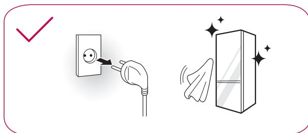
Ao limpar as aberturas exteriores de ventilação do equipamento com um aspirador, desligue o cabo de alimentação da tomada, de forma a evitar descargas de eletricidade estática que possam danificar o sistema eletrónico ou causar choques elétricos.
