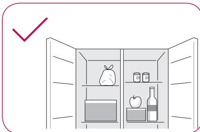
Ne töltse túl a készüléket. A hideg levegő nem tud megfelelően keringeni, ha a készülék túl van töltve.
