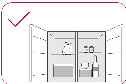
Não preencha em demasiado o equipamento, o ar frio não circulará adequadamente se o aparelho estiver demasiado cheio.
