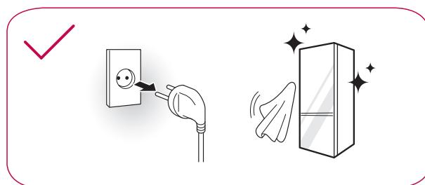
Miközben a készülék külső szellőzőnyílásait porszívóval tisztítja, húzza ki a tápkábelt a fali aljzatból az elektronikát károsító vagy esetlegesen áramütést okozó elektrosztatikus kisülések elkerülése érdekében.
