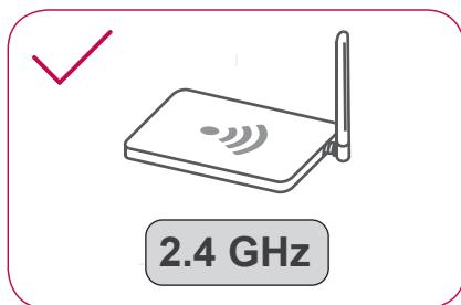
Dersom det er for stor avstand mellom enheten og ruteren din, kan signalet være for svakt og koblingen feilkonfigurert. Flytt ruteren slik at den er nærmere enheten.
