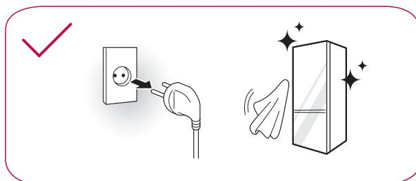
Când curățați orificiile de aerisire exterioare ale aparatului cu ajutorul aspiratorului,cordonul de alimentare trebuie deconectat de la priză pentru a evita orice descărcare electrostatică ce ar putea deteriora echipamentele electronice sau ar putea duce la electrocutare.
