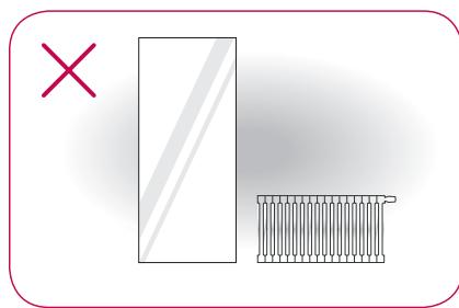
Sprawdzić miejsce instalacji urządzenia i przenieść go w miejsce oddalone od źródeł ciepła.
