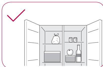
Urządzenia nie należy przepełniać. W przepelnionym urządzeniu zimne powietrze nie może prawidłowo cyrkuluować.
