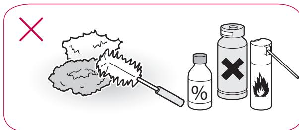
Nu pulverizați apă sau substanțe inflamabile (pastă de dinți, alcool, diluant, benzen, lichid inflamabil, abraziv, etc.) pe suprafața interioară sau exterioară a aparatului pentru a-l curăța. Pentru exteriorul aparatului, utilizați un burete curat sau o lavetă moale și un detergent delicat în apă caldă. Nu utilizați produse de curățare abrazive sau aspre. Uscați complet cu o lavetă moale.
