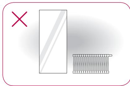
Proverite oblast instalacije i ponovo ga instalirajte dalje od objekata koji stvaraju toplotu.
