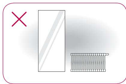
Preverite prostor za namestitev in napravo odmaknite od drugih toplotnih naprav.
