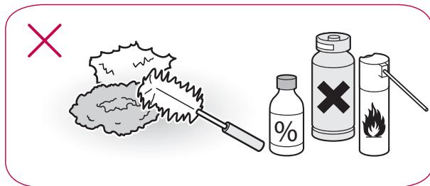
Não pulverize água ou substâncias inflamáveis (pasta de dentes, álcool, diluente, benzeno, líquido inflamável, abrasivo, etc.) sobre o interior ou exterior do aparelho para o limpar. Para o exterior do equipamento, utilize uma esponja limpa ou um pano macio com um detergente suave em água quente. Não utilize produtos de limpeza abrasivos ou agressivos. Seque minuciosamente com um pano macio.
