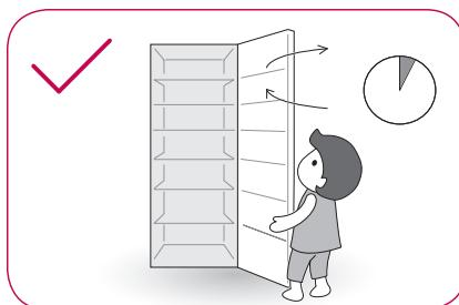
Otvaranje vrata tokom dužih perioda može da dovede do značajnog povećanja temperature u odeljcima uređaja.
