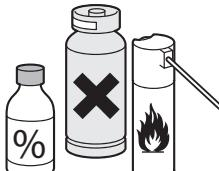
Ne škopite z vodo ali vnetljivimi snovmi (zobna pasta, alkohol, razredčevalec, benzol, vnetljiva tekočina, brusilo, itd.) v notranjosti ali zunanjosti naprave, da bi jo očistili. Za zunani del naprave uporabite čisto gobo ali mehko kropo in nežen detergent v topli vodi. Ne uporabljajte sredstva za poliranje. Temeljito posušite z mehko kropo.
