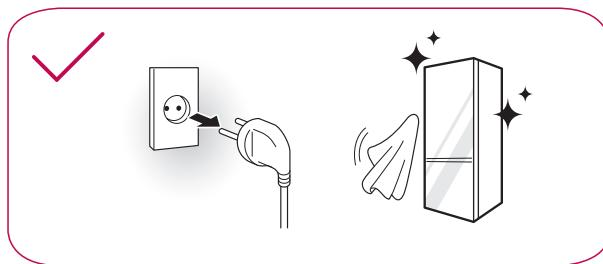
Hvis du rengjør utsiden av ventilasjonsåpningene på produktet med støvsuging, bør strømkabelen være trukket ut av stikkontakten for å unngå statiske utladninger som kan skade elektronikken eller gi elektriske støt.
