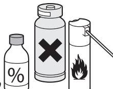
Non spruzzare acqua o sostanze infiammabili (dentifricio, alcool, diluente, benzene, liquidi infiammabili, materiale abrasivo, ecc.) all'interno o all'esterno dell'elettrodomestico per pulirlo. Per la parte esterna dell'elettrodomestico, utilizzare una spugna o un panno morbido pulito imbevuto di acqua calda e un detergente delicato. Non adoperare detergenti potenti o abrasivi. Asciugare perfettamente con un panno morbido.
