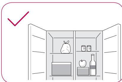
Naprave ne prenapolnite. Hladen zrak ne more pravilno krožiti, če je naprava prenapolnjena. Zagotovite dovolj prostora med shranjeno hrano. Tako bo lahko hladen veter krožil enakomerno, s čimer boste zmanjšali račun za elektriko.
