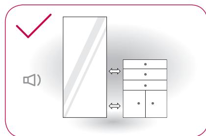
Regolare la posizione di installazione in modo da lasciare spazio sufficiente attorno all'apparecchio.
