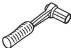
Торцевой ключ 10 мм и 6 мм
