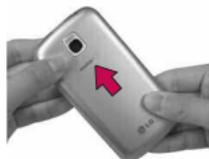
3. Vuelva a colocar la tapa de la batería sobre la parte posterior del teléfono (como se muestra en la figura). Aplique una presión constante hacia abajo hasta que la tapa de la batería encaje en su lugar.
