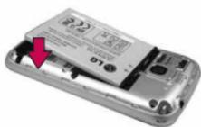
2. Alinee los contactos de la batería con los terminales que se encuentran cerca de la parte superior del teléfono y luego presiónela para encajarla en su lugar.
