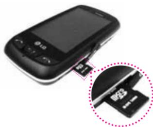
2. Inserte la tarjeta microSD™ (vendida por separada) con el logo orientado hacia arriba hasta que encaje en la ranura. Si inserta la tarjeta en la dirección equivocada, podría dañar su teléfono o su tarjeta.
