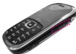
1. Localice la ranura de la microSD™ a la derecha del teléfono y destape suavemente la abertura de la ranura (la tapa permanece adosada al teléfono para que no la pierda).
