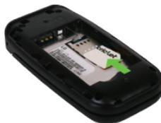
3. Inserta la batería, y asegúrate de que los conectores estén alineados.
