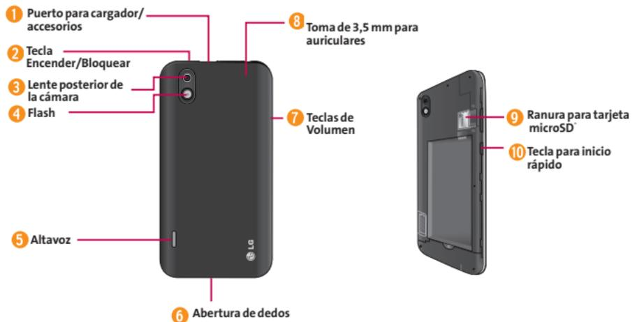
1. **Puerto para cargador/accesorios** permite conectar el cargador del teléfono o un cable USB opcional. **¡PRECAUCIÓN!** Si introduce un accesorio en el puerto incorrecto, puede dañar el teléfono.
