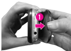
2. Alinee los contactos de la batería con los terminales del compartimiento de la batería.
