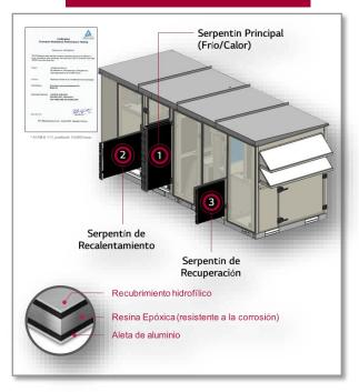
Viene con una caja de recuperación de calor integrada lo que le da mayor flexibilidad en la operación, lo cual permite tener unidades enfriando, calentando y deshumidificando de manera simultánea
